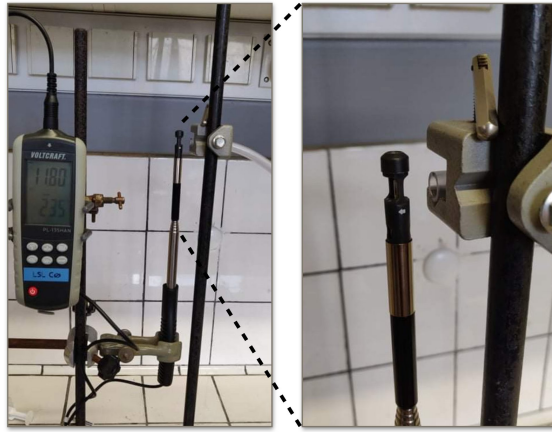
FIGURE 2.8 – Photo du dispositif de mesure (à gauche l'anémomètre à fil chaud et à droite la sortie du tube d'injection)
